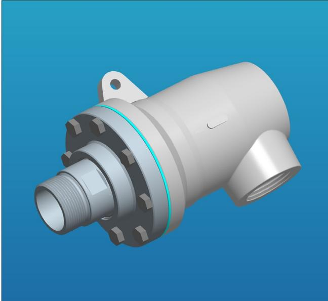
Die Drehdurchführungen der Baureihe HT sind wegen der großzügig ausgelegten Rotor-Zweifachlagerung "selbsttragend", und gewährleisten eine hohe und dauerhafte Laufruhe. Für völlige Wartungsfreiheit während des Betriebes sorgen die Selbstschmiereigenschaften des verschleißarmen Lagermaterials. Die sich selbst justierenden Kallottendichtungen sind schockunempfindlich, weil sie nur druckbeansprucht werden und die Druckbelastbarkeit von Kohlegraphit bis zu 5 mal höher als die unter Zug ist.
