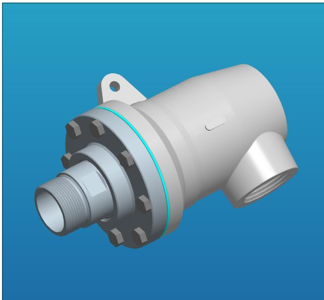
Die Drehdurchführungen der Baureihe HT sind wegen der großzügig ausgelegten Rotor-Zweifachlagerung "selbsttragend", und gewährleisten eine hohe und dauerhafte Laufruhe. Für völlige Wartungsfreiheit während des Betriebes sorgen die Selbstschmierereigenschaften des verschleißarmen Lagermaterials. Die sich selbst justierenden Kalottendichtungen sind schockunempfindlich, weil sie nur druckbeansprucht werden und die Druckbelastbarkeit von Kohlegraphit bis zu 5 mal höher als die unter Zug ist.
